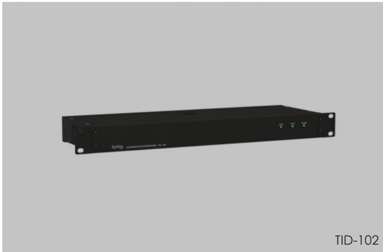
TID-102是一款设计为整合式系统管理器 以及信号管理器 系列一起使用。该单元和火警面板整合使用，一旦被触发，即开始执行自动疏散步骤。内置记忆体储存疏散语音信息，程序里能够设置执行自动化“夹层”（N+1，N，N-1）疏散程序或者简单的全区呼叫的总疏散撤离程序。它具有60个干接点输入。
